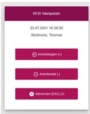
Beachten Sie, dass, wenn keine Begin- oder Endauswahl getroffen wird und die Zeitüberschreitung auftritt, kein Datensatz gespeichert wird, dass das RFID-Tag gescannt wurde.
